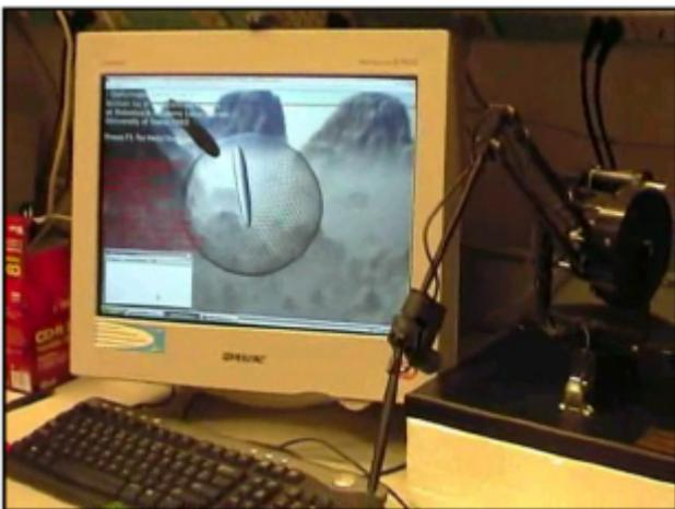
Ad esempio il **Phantom della Sensable** simula il contatto di un oggetto tramite una bacchetta, mentre quello della **Force Dimension** tramite una sfera. Entrambi sono in grado di simulare il contatto di un polpastrello con l'oggetto attraverso un ditale rigido. Quando ci si discosta da questi tipi di contatto la sensazione tattile diventa meno realistica. In ogni caso sono convinto che lo sviluppo tecnologico sarà in grado di superare tali vincoli.
