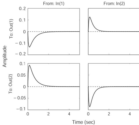
Fig. 9. The actual step response tracking error.
